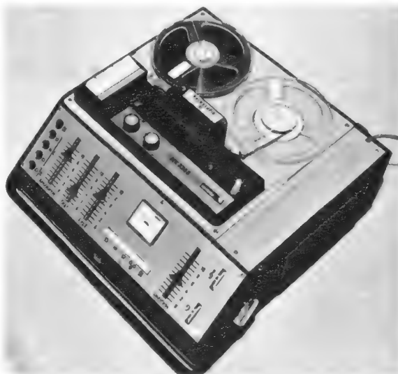
Bild 1. Das Tonbandgerät MK 3335 mit drei Antriebsmotoren und eingebautem Mischpult
